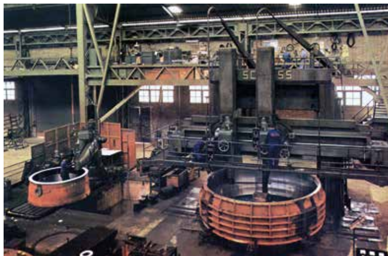
Torno vertical de dos cabezales SHIESS 3KV ø 3000/6000 torneando la cámara del rodete de una turbina tipo Kaplan para la central hidroeléctrica de Arbon (Asturias), 1970.
