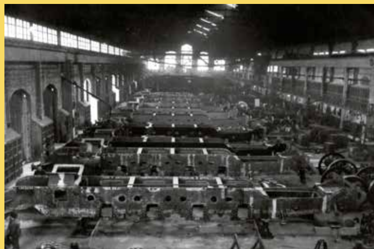
Vista de la nave de montaje de locomotoras de vapor; en posición, los primeros 10 bastidores de las locomotoras MIKADO, 1953.
