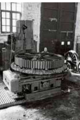
Talladora de engranajes MAAG SH 180, en su momento la de mayores dimensiones y capacidad existente en España, operada por J. Sánchez, 1953.
