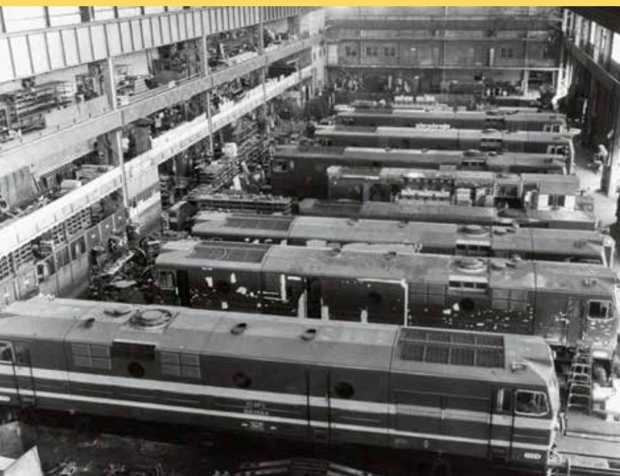
[Abajo] Locomotoras diesel eléctricas GM 16- RENFE 1900 en proceso montaje, en la nave de montaje de locomotoras, 1965.
