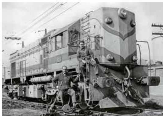
Locomotora diesel eléctrica MACOSA GL 12 (RENFE 1401) con los colores originales en periodo de pruebas, conducida por José Sorando (MACOSA) y Alberto Ten (RENFE). Esta fue la primera locomotora diesel eléctrica de línea construida en España, 1963.
