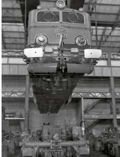
Maniobra de levante ante bogíes de la locomotora eléctrica RENFE 7642 en reparación, en la nave de montaje de locomotoras eléctricas, 1961.
